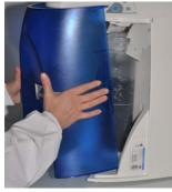
Öffnen Sie die vordere Abdeckung (es kann sein, dass Sie dafür den Endfilter entfernen müssen), damit das System in den Modus STANDBY übergeht (C).
