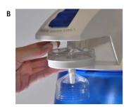
Suchen Sie das Entlüftungsventil (das nicht an allen Typen von Endfiltern vorhanden ist) oben auf dem Endfilter.
