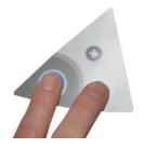
Drücken Sie die Haupttaste und die Taste "-" gleichzeitig, um das Menü aufzurufen. Am Display wird F01 angezeigt.
