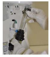
Benutzen Sie die zum Lieferumfang des UV-Ersatzlampen-Kits gehörenden Handschuhe. Führen Sie die UV-Lampe vorsichtig in das UV-Lampen-Gehäuse ein (G).
