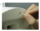
• Entfernen Sie den Entlüftungsfilter und bringen Sie den hellen Winkelfitting aus dem Reinigungskit (D) an.
