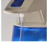
• Stecken Sie ein Ende des Tygon-Schlauchs auf das Ende des Schlauchanschlusses (D). Stecken Sie das andere Ende des Tygon-Schlauchs in einen Abfluss.
