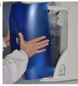
Öffnen Sie die vordere Abdeckung (es kann sein, dass Sie dafür den Endfilter entfernen müssen), damit das System in den Modus STANDBY übergeht (M).
