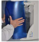
Öffnen Sie die vordere Abdeckung(es kann sein, dass Sie dafür den Endfilter entfernen müssen), damit das System in den Modus STANDBY übergeht (C).
