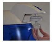
• Installieren Sie den Endfilter.
