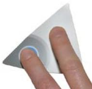
Drücken Sie die Haupttaste und die Taste "+" gleichzeitig, um das Menü aufzurufen. Am Display wird C01 angezeigt.
