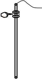
Bewegen Sie den Schwimmer auf dem Füllstandssensor in die höchste Position (was einem vollen Tank entspricht). Vergewissern Sie sich, dass sich der Füllstand "Tank voll" unter der Überlauföffnung befindet.
