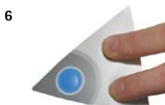
Drücken Sie die Tasten "+" und "-" gleichzeitig, um den niedrigsten Wasserstand einzugeben. Das Display verlässt die Menüoption und das System geht in den Modus TANK FÜLLEN über.
