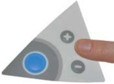
Drücken Sie die Taste "+" bzw. "-", um nicht temperatur-kompensierte Leitfähigkeitseinheiten auszuwählen:  $\mu\text{S}/\text{cm}$ .
