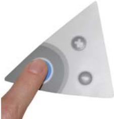
Drücken Sie die Haupttaste 3-mal. Am Display wird C04 angezeigt. Der Balken, der dem höchsten Tankfüllstand entspricht, blinkt. Dies bedeutet, dass jetzt der höchste Wasserstand kalibriert werden kann.
