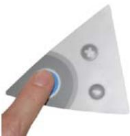
Drücken Sie die Haupttaste 4-mal. Am Display wird C05 und die Anzahl der auf dem UV-Lampen-Zeitgeber verbleibenden Tage angezeigt.
