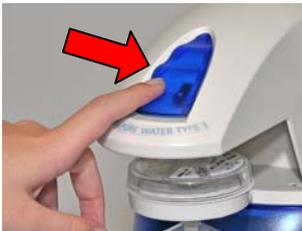
Um die Wasserentnahme zu stoppen, die Entnahmetaste erneut drücken.
