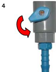
Öffnen Sie das Tankauslassventil. Entleeren Sie den Tank bis auf seinen niedrigsten Füllstand.
