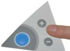
Drücken Sie die Taste "+" bzw. "-", um die exakt benötigte Produktwassermenge einzustellen (in Litern). Sie können das Wasservolumen von 0,25 l bis 9,75 l in 0,25 l-Schritten einstellen.
