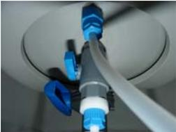
Schließen Sie den Schlauch mit 6 mm Durchmesser mit einem 8- bis 6-mm-Fitting an den Boden des Tanks und den Füllstandssensor des Tanks an den Füllstandssensor-Anschluss an.
