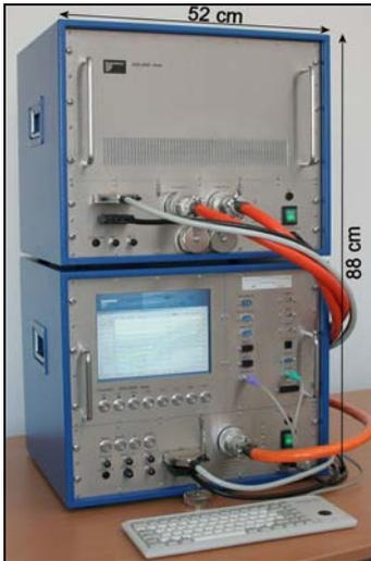
Das parametrische Sedimentecholot SES-2000 *medium* besteht aus zwei Elektronikeinheiten (Top side units) und einem Schallwandler:
