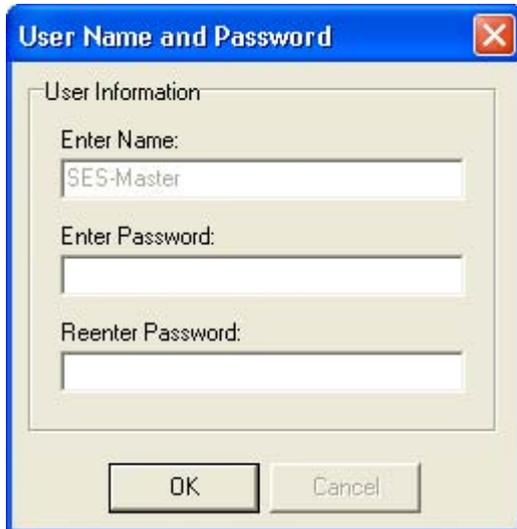
Wenn SES Config das erste Mal ausgeführt wird, erscheint ein Dialog zum Setzen eines Master-Passwortes. Der „SES-Master“ kann später neue Nutzerprofile anlegen later on will be able to create new user profiles. Die Werkseinstellung ist „sesmaster“.
