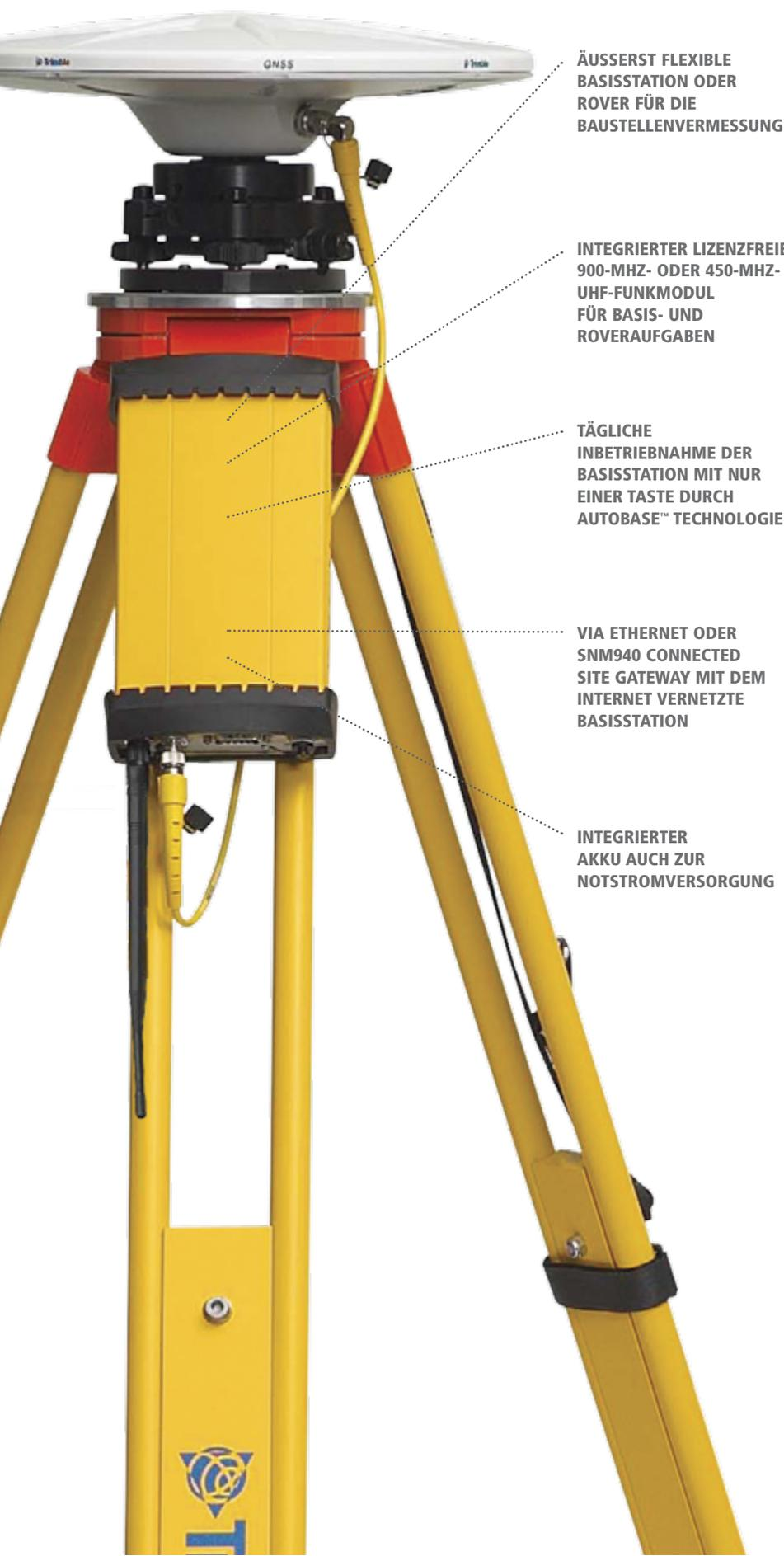
ÄUSSERST FLEXIBLE BASISSTATION ODER ROVER FÜR DIE BAUSTELLENVERMESSUNG
