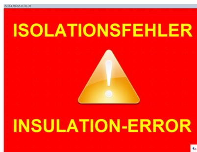
Bei Erscheinen dieser Anzeige sollte die Bordeinheit sofort abgeschaltet werden (Notaus) und der Unterwassereinsatz abgebrochen werden. Die Ursache muss dann an Deck von einem Elektroniker beurteilt werden.
