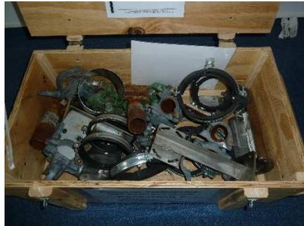
Material zur provisorischen Befestigung der Kameras und der LED-Strahler an Einsatzgeräten (z.B. MUC).
