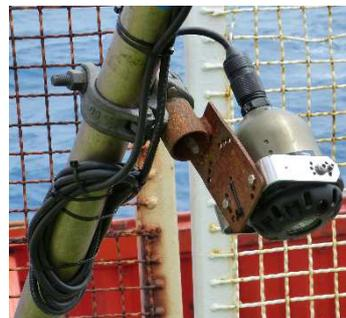
Auf den Bildern hier sieht man, das die Stecker von Kamera und Lampe nicht geschützt sind. Diese wurden mit den provisorischen Befestigungen am Gerät angebracht. Hier sollten bei regelmäßigen Einsatz entsprechende Halter mit Schutzbügeln angefertigt werden.
