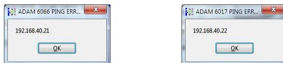
Warten sie etwa 30 Sekunden und versuchen es erneut. Kommt dauerhaft keine Verbindung zu Stande, liegt ein Fehler vor. Prüfen sie die Signalleuchte an der Bord-Telemetrieinheit. Ist diese Verbindung vorhanden? Schalten sie die Bordeinheit aus und starten sie neu.
